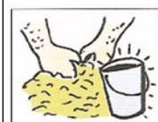
Mélange des prélèvements dans un seau propre
